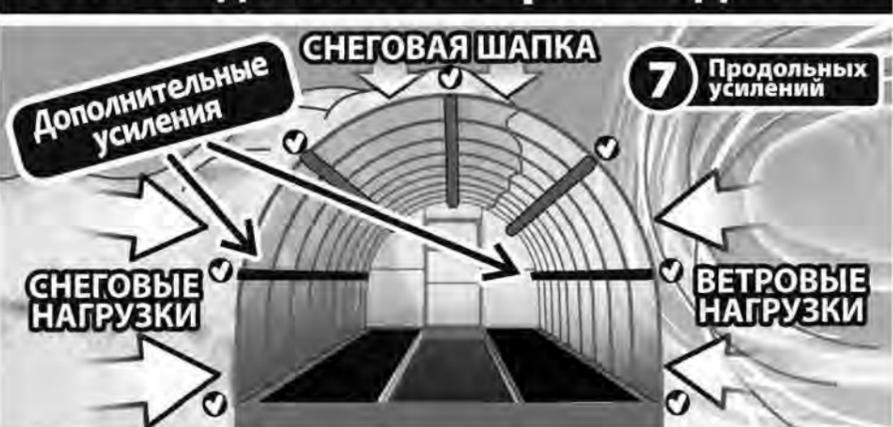
**Прочный оцинкованный каркас**
